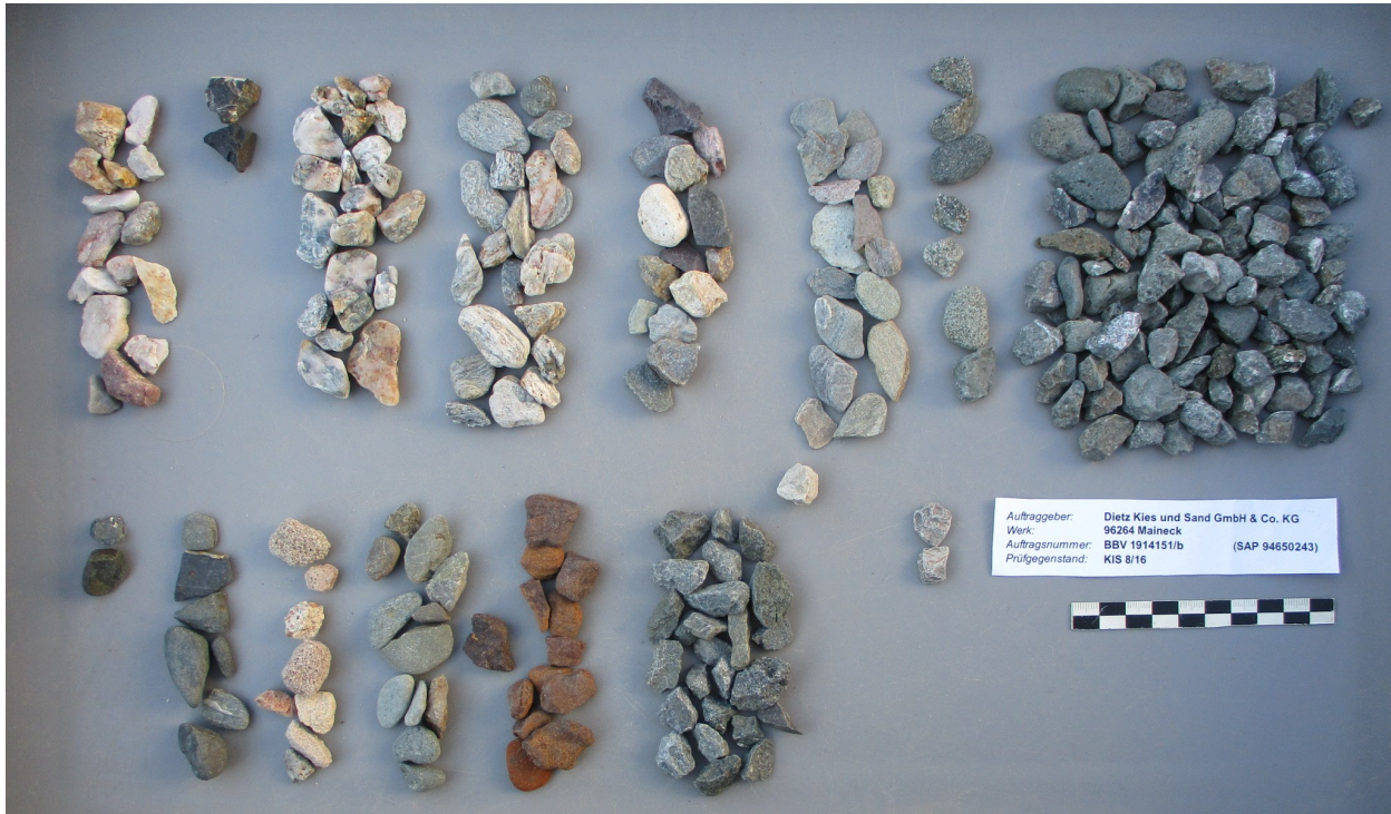
Foto 1: Körnung 8/16 mm, Gesteinsarten (von links oben nach rechts unten)
